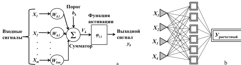
Рисунок 1. Нелинейная модель нейрона (а) и архитектура нейронной сети (b)
