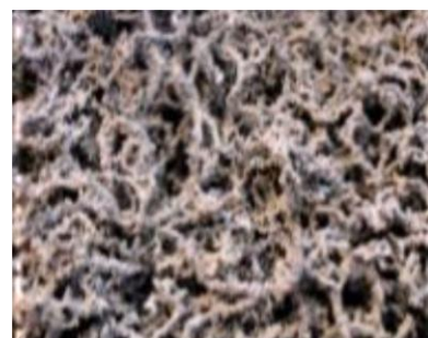
Рисунок 3. Катализатор после отжига при 500-550 °С
