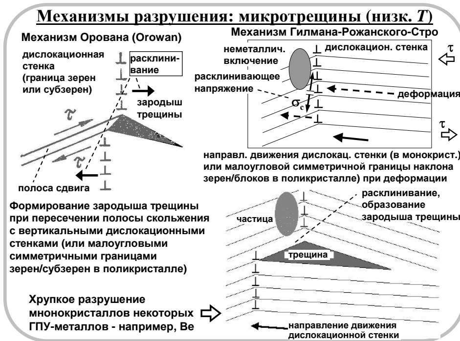
Рисунок 3. Некоторые механизмы формирования микротрещин
