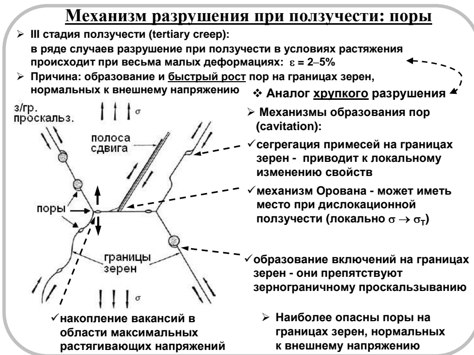
Рисунок 4. Механизм формирования и роста пор при ползучести
