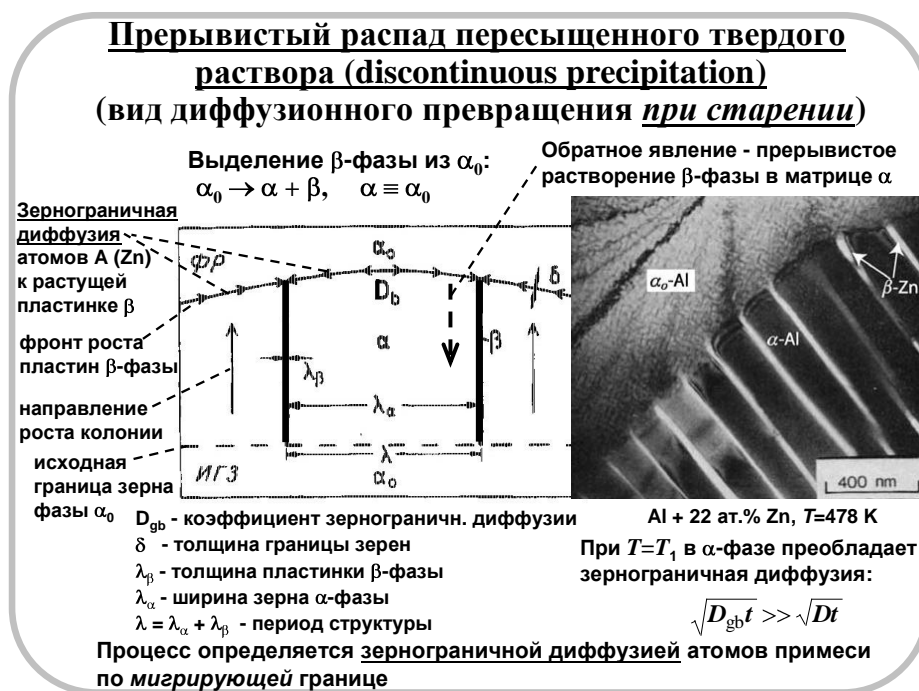
Рисунок 7. Механизм прерывистого распада твердого раствора
