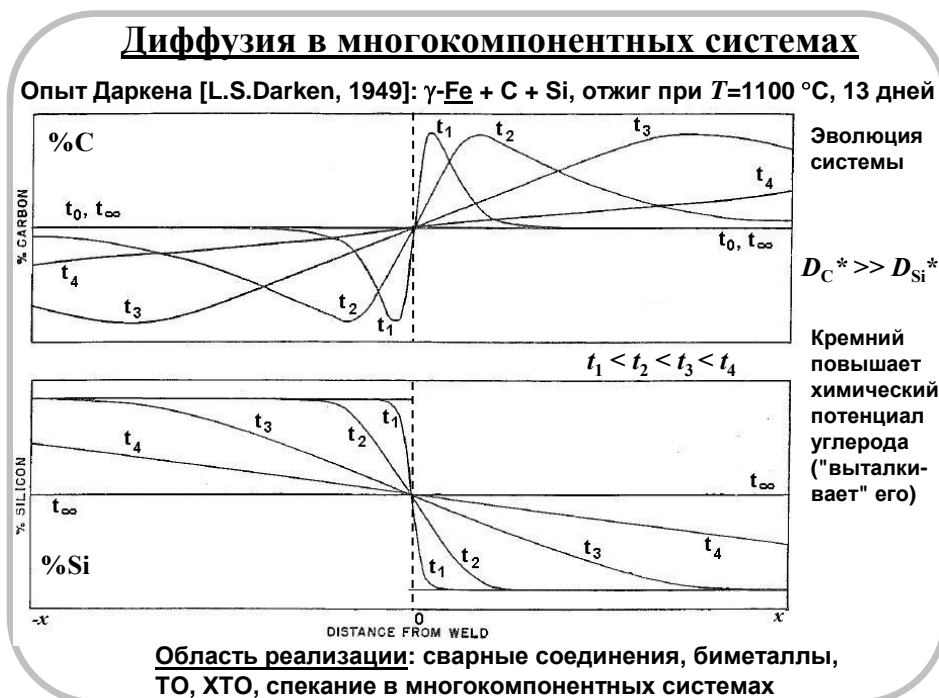
Рисунок 6. Диффузия в многокомпонентном твердом растворе
