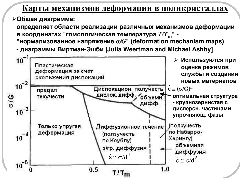
Рисунок 5. Общий вид диаграммы механизмов деформации в поликристаллических материалах (диаграмма Виртман-Эшби)
