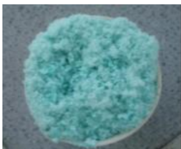
Рисунок 2. Катализатор после обработки при 140 °С
