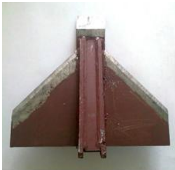
Рисунок 2. Упрочненный корпус чизельного плуга.
