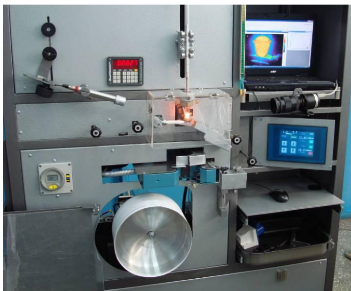
Рис.1 Установка для получения протяженного «толстого» быстрозакаленного провода методом Улитовского-Тейлора (совместная разработка НПП «ВИЧЕЛ» и ИМЕТ РАН)
