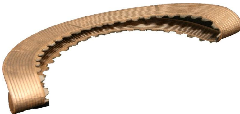
Рисунок 1 - Фрикционный диск трактора Т-150 с паяным с двух сторон фрикционным слоем после испытаний на прочность соединения
