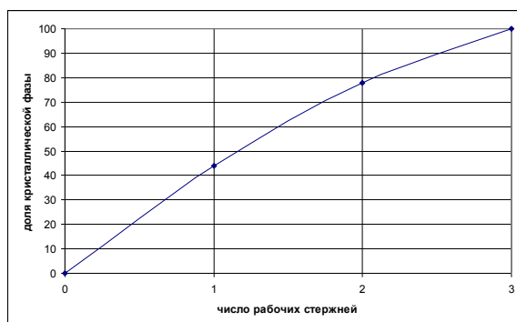
Рис.3. Зависимость доли кристаллической фазы по данным ДСК анализа в аморфном проводе сплава Co_{69}Fe_4Cr_4Si_{12}B_{11} от количества рабочих стержней (d=10мм, T= 420°С) при непрерывном деформировании изгибом.
