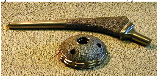
Рис. 3. Тазобедренный имплантат: чашка и ножка после нанесения титанового покрытия
