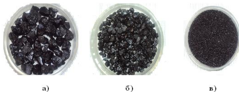
Рис.1 Различные измельченные фракции угля: а – образец угля до обработки, диаметр фракции d_{фрак} = 10мм ; б – образец угля после обработки, диаметр фракции d_{фрак} = 5мм ; в - образец угля в виде порошка после обработки, диаметр фракции d_{фрак} \leq 1мм .
