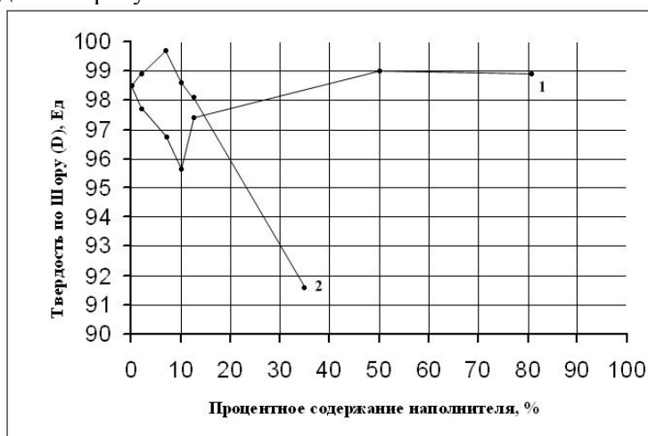
Рис. 2 Графики зависимости твердости по Шору (D) от процентного содержания наполнителя: 1 – СВМПЭ + Cu, 2 – СВМПЭ + NB;
