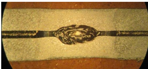
Рис. 1 Вид шлифа покрытия ФБХ6-2 после контактной сварки.
