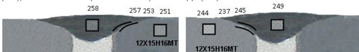
Рис. 3. Средние значения микротвердости (по данным десяти измерений) в обозначенных линиями и прямоугольниками зонах
